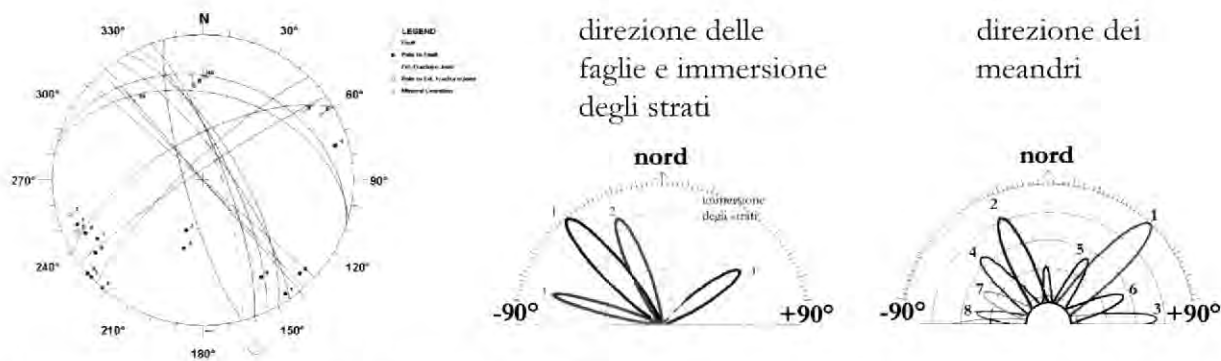
5. A sinistra: Proiezioni equiareali (reticolo di Schmidt, emisfero inferiore) dei dati relativi a tutte le faglie; al centro: distribuzione delle faglie e dell'immersione degli strati; a destra: distribuzione dei meandri
